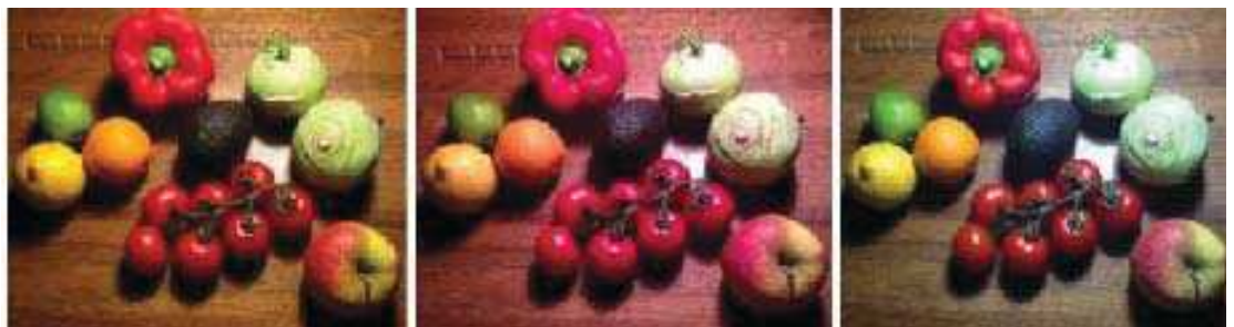
Farbwiedergabe in Abhängigkeit der Farbtemperatur/ Quelle: Irs
