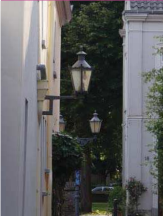
Altstadtleuchte als Wandleuchte, einfach Lichtpunkthöhe ca. 3,00m bis 5,00m
