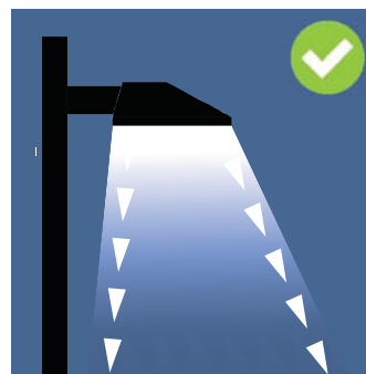
Mastleuchte mit Lichtlenkung
